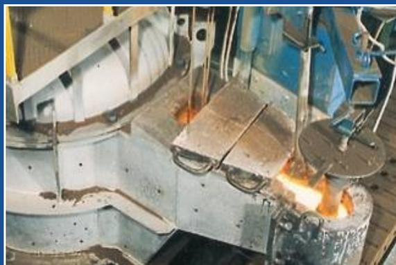
Разливочные печи для автоматической подачи жидкого металла к формовочной линии
