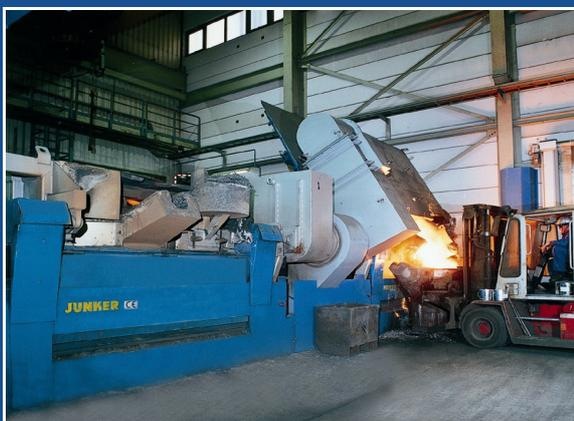
Среднечастотные тигельные индукционные печи MFT согласно техническим требованиям заказчика
