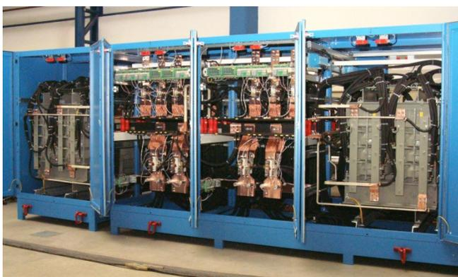
12-импульсная тиристорная система преобразователя частоты
